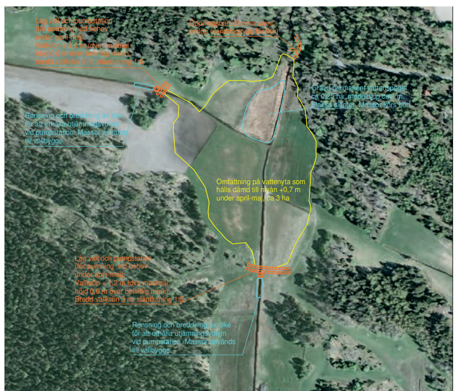
Planritning – våtmark för fisklek, Kavarödiket.
